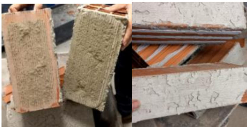
Figura 26 – Rompimento realizado pelo ensaio de tração na flexão – Argamassa convencional
