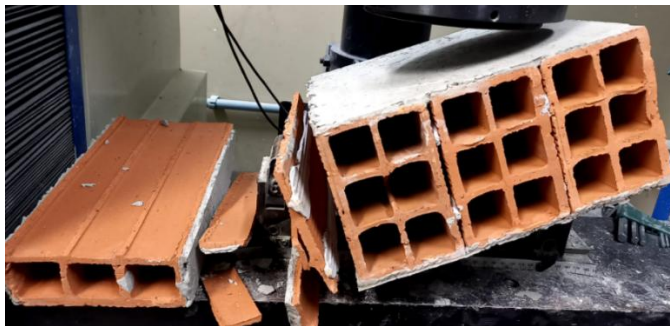
Figura 24 – Rompimento realizado pelo ensaio de tração na flexão – 2 cordões
