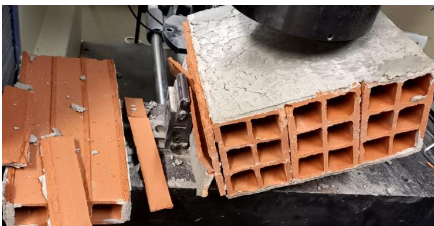
Figura 27 – Rompimento realizado pelo ensaio de tração na flexão
