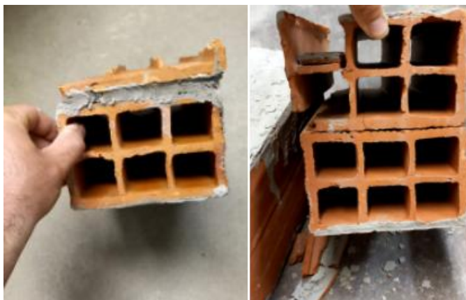
Figura 21 – Amostras rompidas (Compressão axial)
