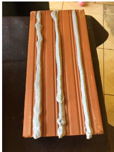
Figura 16 – Aplicação da argamassa polimérica – 3 cordões
