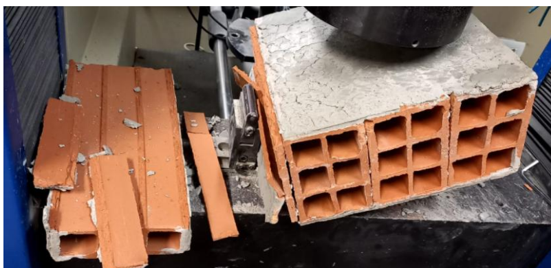
Figura 25 – Rompimento realizado pelo ensaio de tração na flexão – 3 cordões
