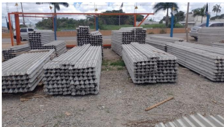
Figura 5 – Laje pré-fabricada convencional.
